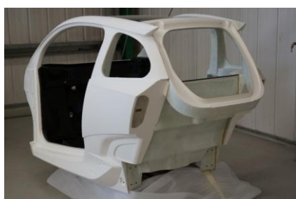
Exemple du projet de véhicule électrique VeIV de PSA : structure composite à matrice époxy (Photos PSA)
